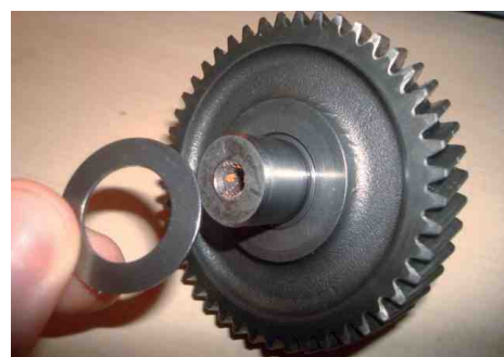
Anlaufscheibe Ni/P>10 wärmebehandelt
