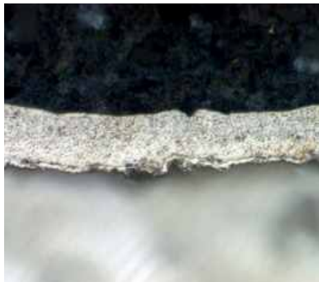
Querschliff Schicht Mikrokristallin Ni/P<9
